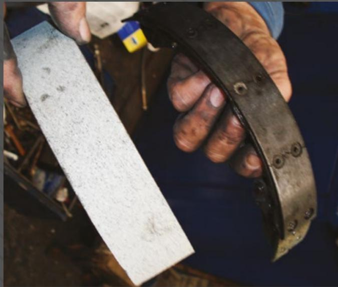
La banda de freno (izquierda) se comercializa separada del soporte (derecha), lo cual obliga a manipularla para poder unirlos. En este proceso se liberan las fibras de asbesto, exponiendo al mecánico.
