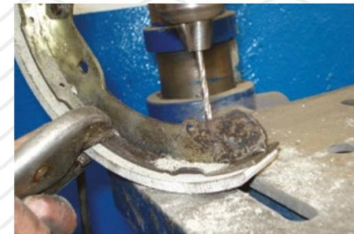
Perforación con taladro de la banda de freno, para poner posteriormente los remaches. Se aprecia el material que se libera de la banda.
