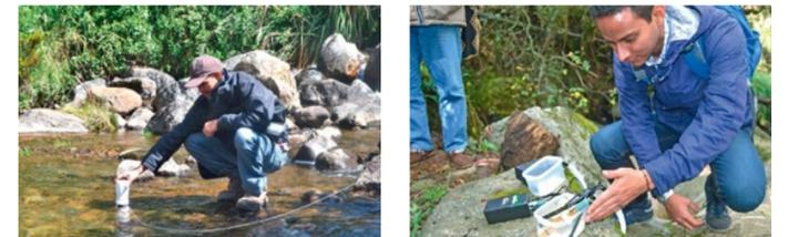
Existen dos tipos de medidores: el primero registra la conductividad y temperatura y el segundo mide cuatro variables: PH, temperatura, conductividad y oxígeno disuelto.
