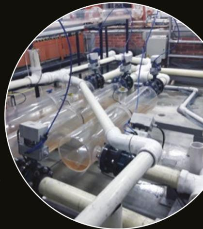
Prototipo funcional uniandino de un sistema de control en tiempo real para alcantarillados.
