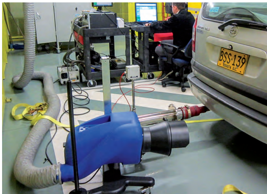
► En el Laboratorio de Aire de Los Andes se hacen pruebas para medir los gases contaminantes y mejorar la eficiencia energética y mecánica de los vehículos.
