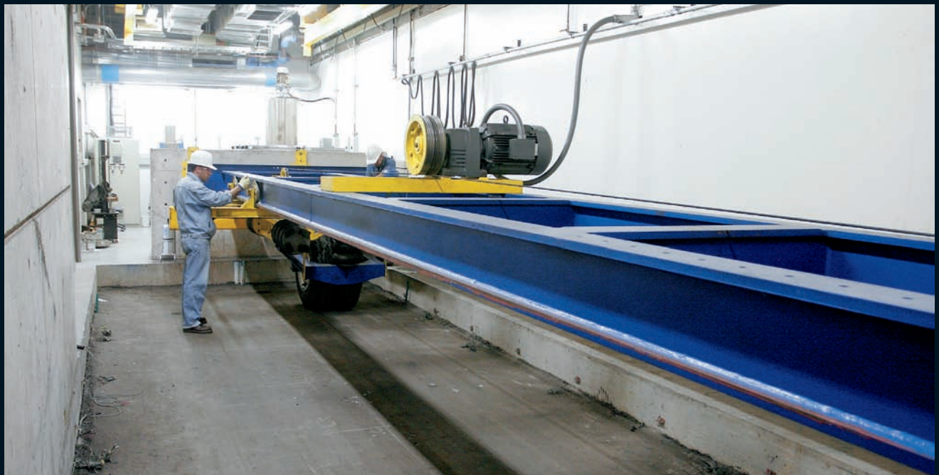
Mediante el sistema de llantas duales se aplica la carga sobre el pavimento.
