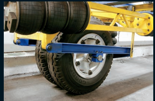
Mediante el sistema de llantas duales se aplica la carga sobre el pavimento.
