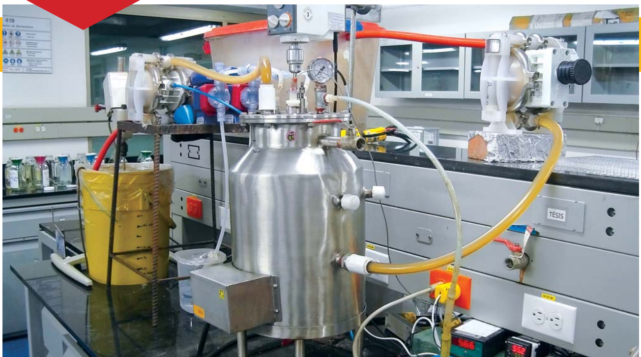
En el biorreactor del Laboratorio de Ingeniería Civil y Ambiental se llevan a cabo las pruebas para la producción de hidrógeno, a partir de la fermentación de desechos orgánicos y aguas residuales.
