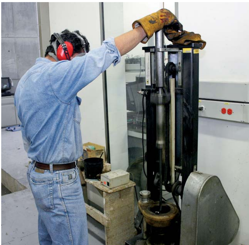
En el Laboratorio de Mezclas Asfálticas, los investigadores determinaron en qué proporción debe mezclarse el caucho molido de las llantas con el asfalto, teniendo en cuenta las características del material producido en Colombia.
