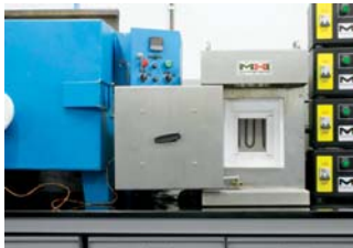
En hornos de altas temperaturas (hasta 1.600°C) se hacen procesos de cocción/quemado o de sinterización.
