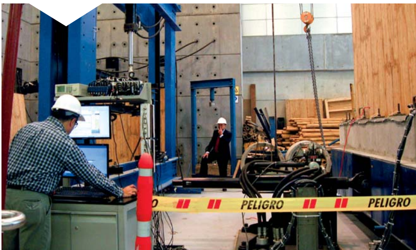
El corazón de la mesa vibratoria, donde se hicieron las pruebas de resistencia de la casa de guadua laminada, es el gato hidráulico que le otorga una capacidad dinámica máxima de 50 toneladas, con un control diseñado por el Departamento de Ingeniería Eléctrica y Electrónica.
