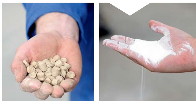
▶ Izquierda, pellets de PVC, PVC reciclado y cisco de café, punto de partida para woodpecker. Derecha, PVC puro.
