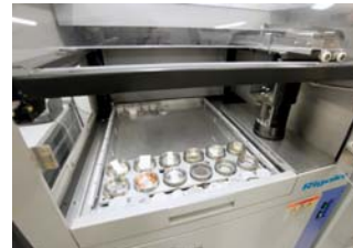
El espectrómetro de Rayos X muestra las fases que forman los elementos de las piezas. Por ejemplo, dice si es óxido de carbono u otro componente.
