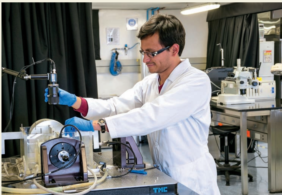
▲ Máquina de ensayos biaxial: Se emplea para la caracterización mecánica de materiales biológicos.
